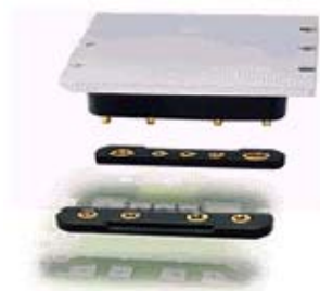
图2. 连接系统包括一对插头底座 (图片前方是输入端插头)，经标准回流焊工序，焊好在电路板上后，再把 DC-DC 转换器 (上方) 装上。
